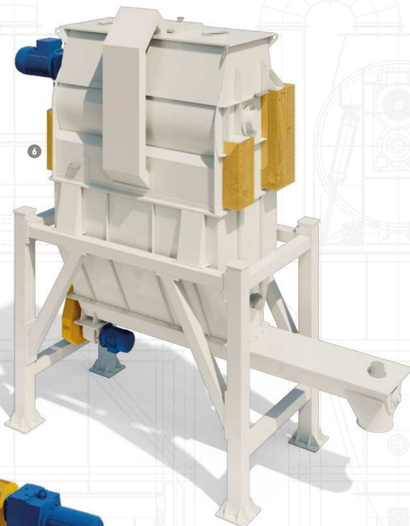
MA/1 - Lt. 2000 A scarico rapido con benna a comando elettro-pneumatico, tramoggia di scarico rapido ed estraattore a coclea. With pneumatic bomb door release, under hopper and screw extractor.
