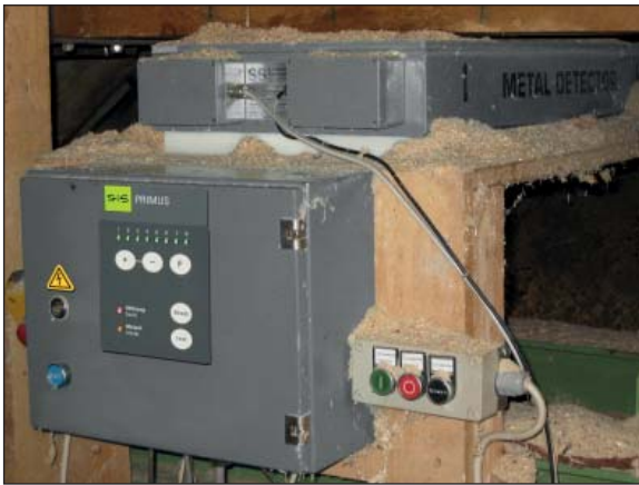
Plate type detector ELS analysing wood off-cuts
